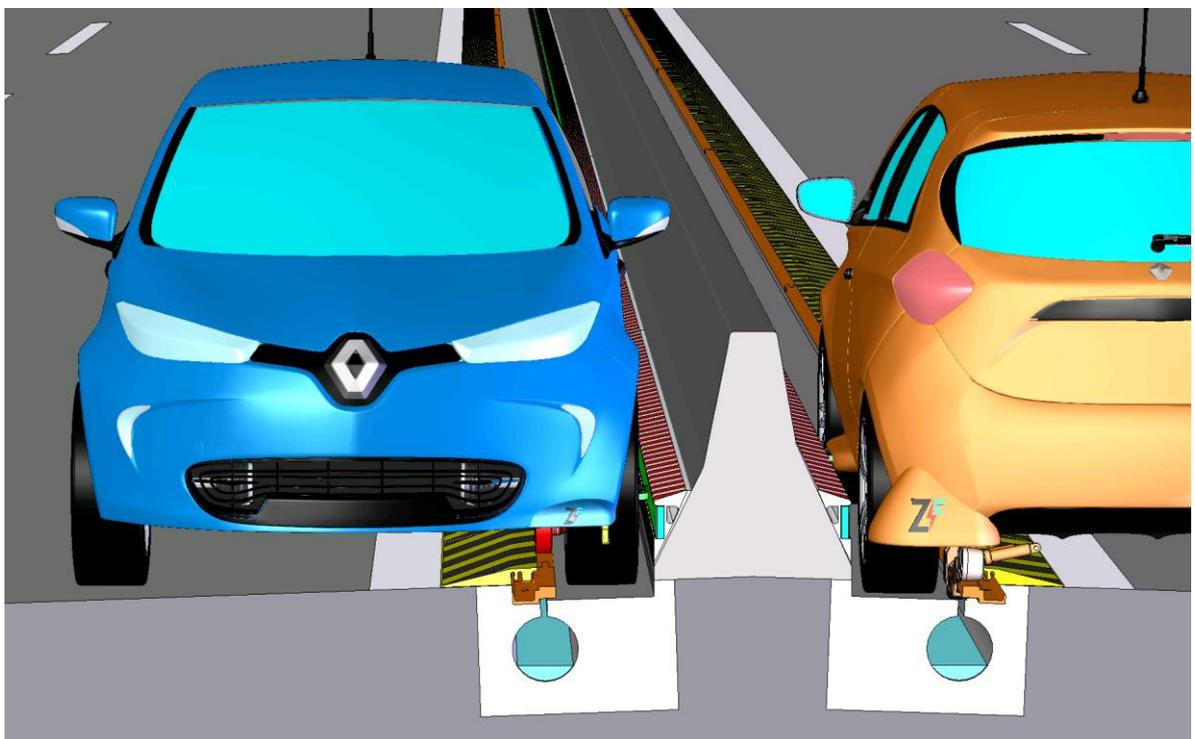
Devant la roue AV gauche, un dispositif multi-capteurs détecte en permanence la distance latérale du véhicule par rapport au mur Jersey et, en mode **ZE-Drive** et de manière fiable, pilote la direction de façon autonome afin de maintenir les roues gauches centrées sur le chemin de roulement de site propre en toutes conditions climatiques.
