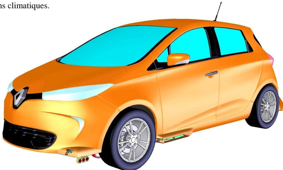
Le rail assure également le retour par la terre (comme en ferroviaire) de l'alimentation TBTS continue, capté par un patin rétractable (en vert au-dessus et en dessous) situé en bas de porte conducteur.
