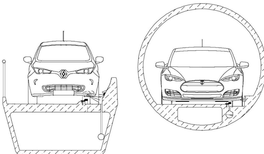
La phase 1 "**Proof of Concept**" de la **JIP** (Projet Industriel Commun) **ZE-Drive** vise à démontrer le caractère aisé de l'entrée/sortie latérale dans un centre de tests routiers. La phase 2 développera la capacité de circulation en pelotons et l'alimentation dynamique en **TBTS** continu 120 volts, tandis que la phase 3 comprendra une installation pilote sur route ouverte pour recueillir des données d'utilisation et présenter la technologie aux utilisateurs et aux acteurs industriels.
