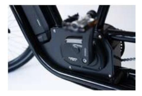
Nos tricycles sont équipés de la motorisation pédalier Shimano Steps DU-E6002 parfaitement adapté au vélo cargo et au transport de charge. De puissance nominal 250W, l'assistance électrique s'enclenche dès le premier coup de pédale, et vous pouvez activer le changement de vitesse automatique asssurant un confort optimal dès le démarrage.
