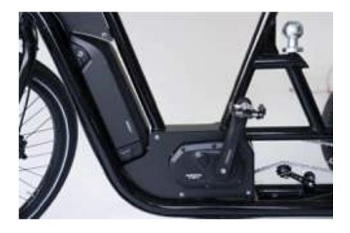
Nos tricycles sont équipés **de batterie Shimano BT-E6010** d'une capacité de **418Wh (36V, 11.6Ah).** Le temps de charge est de 4h, et l'autonomie varie de 30 à 60Km selon la charge et le niveau d'assistance électrique programmée. Robuste, elle supporte à l'usage des températures de -10 degré à +50 degré, et sa durée de vie est de 1000 cycles.
