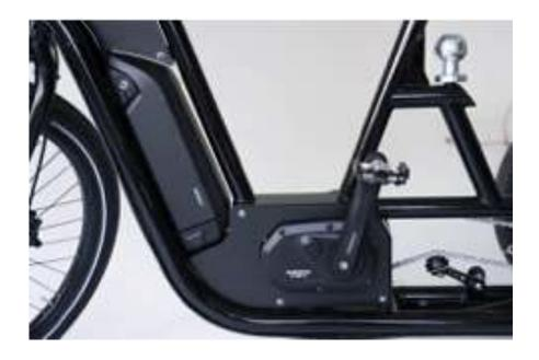
Nos tricycles sont équipés **de batterie Shimano BT-E6010** d'une capacité de 418Wh (36V, 11.6Ah). Le temps de charge est de 4h, et l'autonomie varie de 30 à 60Km selon la charge et le niveau d'assistance électrique programmée. Robuste, elle supporte à l'usage des températures de -10 degré à +50 degrés, et sa durée de vie est de 1000 cycles. Choix Technique:
