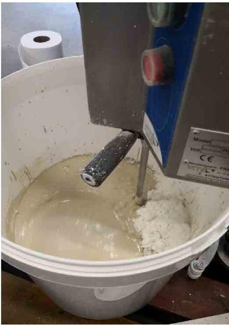
L'Isolfeu est généré par une réaction chimique entre plusieurs composants dont à 95% de l'argile.
